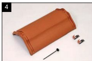
SET hřebenáč vyrovnávací bez hrdla drážkový HO se dvěma příchytkami hřebenáče HO + N a s jedním vrutem Pro napojení na rozdělovací hřebenáč a k vyrovnání délky hřebene.
