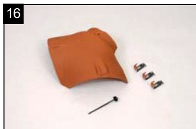
16 SET rozdělovací hřebenáč malý kónický HO s třemi přichytkami hřebenáče HO + N a s jedním vrutem Pro spojení hřebene a dvou nároží.
