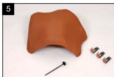
SET rozdělovací hřebenáč drážkový HO s třemi příchytkami hřebenáče HO+N a s jedním vrutem Pro napojení hřebene a dvou nároží. Pro sklony střech 15° až 55°. Připevnění: 3 příchytky HO+N se 3 vruty 4x66 mm nebo jeden utěšňovací vrut.
